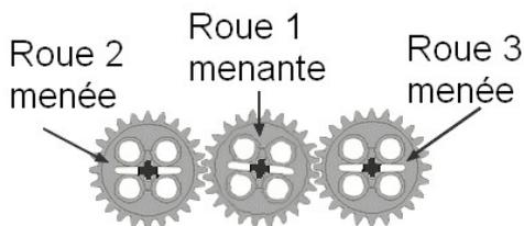
Les roues dentées 1, 2 et 3 s'**engrenent** pour former un ... **engrenage**.
