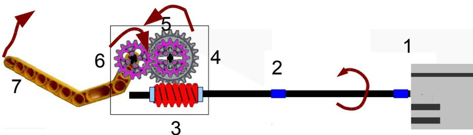
Si l'axe du moteur tourne dans le sens **horaire**, le bras décrit un arc de cercle vers l'avant du robot. Il se baisse.
